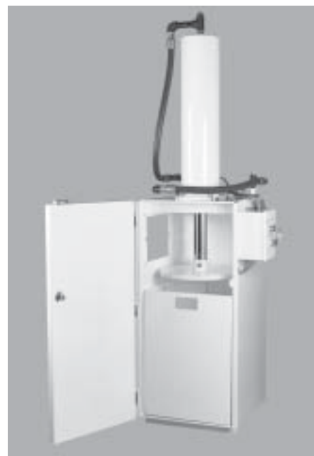
Compactador de sacos "Cruncher" com a porta para descarga aberta.
