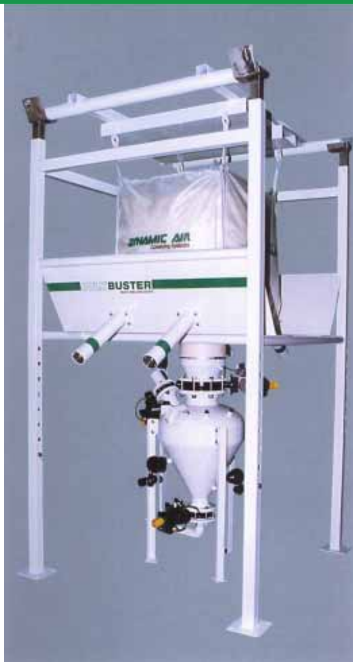
BulkBuster descarregador de bags com massageador, válvulas de descarga e transportador pneumático.
