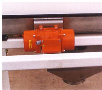
Moega com vibrador proporciona descarga por gravidade de materiais mais grossos.
