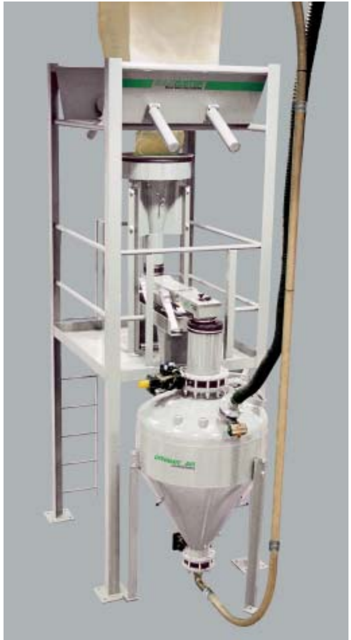
Stations de Vidange de Big-Bags BulkBuster avec dispositifs de massage des sacs, manchette gonflable alimentation vibrante et sas de transport pneumatique.
