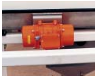
Une trémie vibrante facilite l'écoulement gravitaire des produits grossiers.
