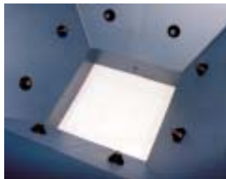
Les aérateurs de trémie Vibra-Jet facilitent l'écoulement des poudres fines.
