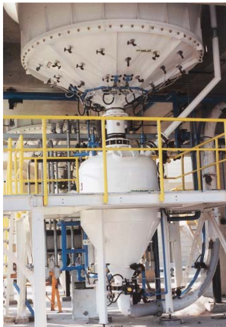
Transportador fase densa com descarregador de silo Vibra-Jet™ para transporte de detergente
