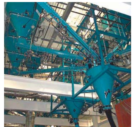
Alimentadores de alta precisão Dyna-Slide™ transportam material de silos-moega de 200 pés cúbicos (6 metros cúbicos) para moegas de pesagem.
