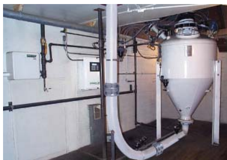
Sistema de transporte pneumático Full Line Concept™ para transporte de milho
