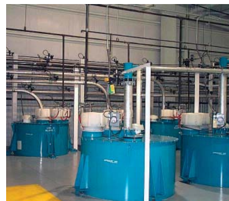
Múltiplas moegas de recebimento de 20 pés cúbicos (0,6 metros cúbicos), com filtros de ventilação de silo Modu-Kleen™ 669
