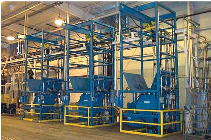
吨袋及小袋卸料机将碳黑放入多路浓相全线概念的传输系统
