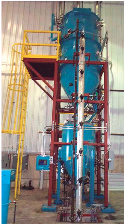
位于卡车卸料结构内的HDV高密度负压全线概念传输系统
