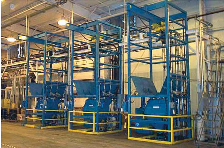
Des dessacheuses et vide-GRVS déchargent le noir de carbone dans des systèmes multiples de transport en phase dense suivant le Concept de la Ligne Pleine™.
