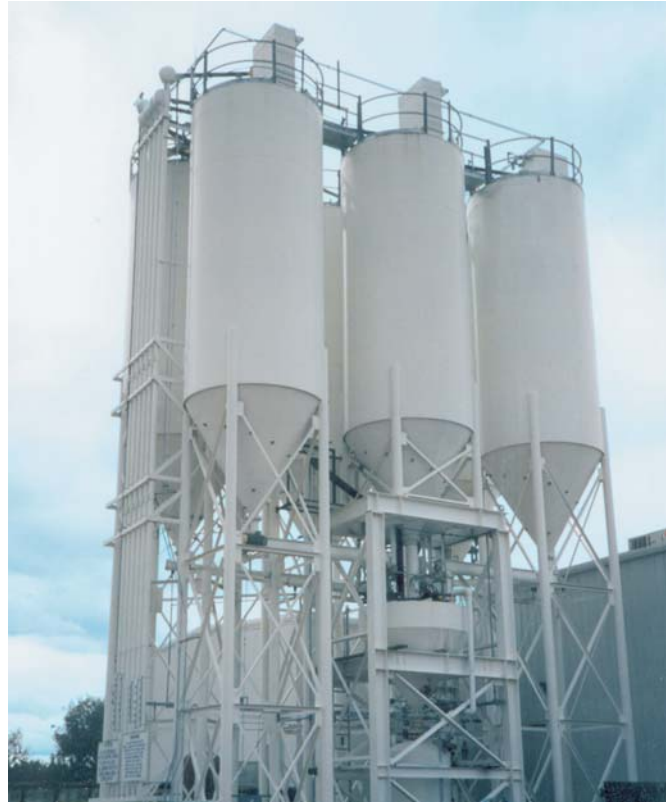
Des systèmes de pesage / traitement par lots et transport incluent les silos de stockage et les structures d'acier.
