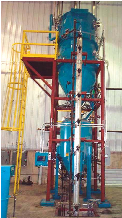
Koncepcja Pełnej Linii™ HDV™ gęsto strumieniowego systemu przenoszenia podciśnieniowego wewnątrz budynku rozładowywania pojazdów
