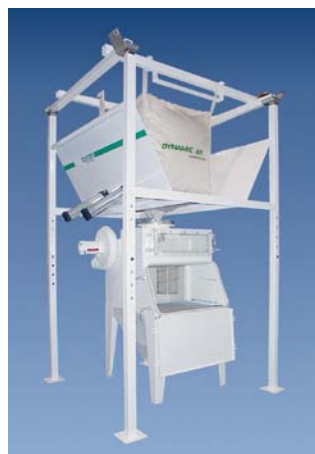
Stacja rozładunku Big Bagów BulkBuster™ z rozrywaczem worków BagBuster™, model F1300
