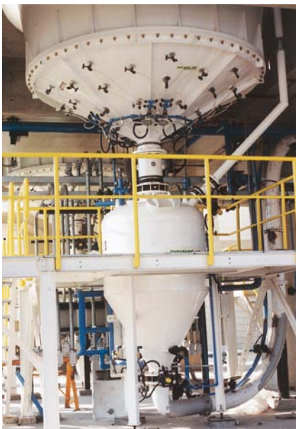
Transporter gęstostrumieniowy z dyszami rozładowniczymi Vibra-Jet™ do przenoszenia detergentów
