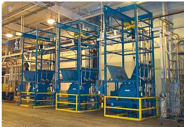
Rozwarkowywacze i stacje rozładunku big bag'ów rozładują sadzę do wielu systemów gęstostrumieniowych systemów przenoszenia typu Konceptja Pelna Linia™ .
