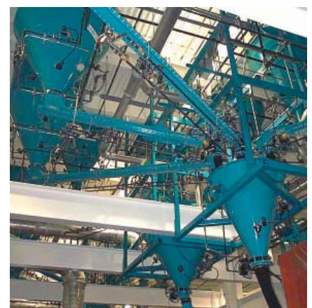
Deslizadores neumáticos de alta precisión Dyna-Slide™ transportan un producto desde un depósito de 6 m³ hasta diversas tolvas pesadoras.
