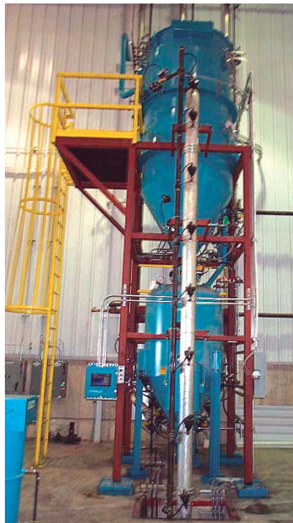
Sistema de transporte HDV™ de alta densidad en vacío Concepto Línea Llena™ en descarga de camiones
